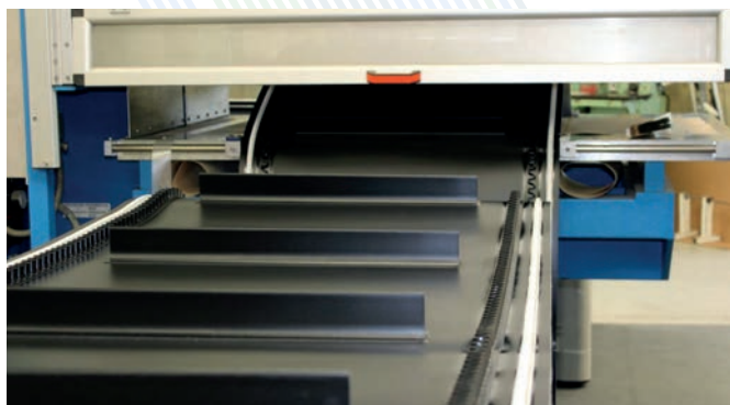
Instalación de tacos con AF
