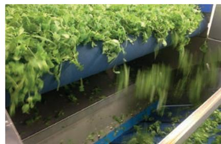
Mögliche Konfektion: mit Keilleisten und Profilen, Compart™-Wellenkanten, Stollen, PU-Stiften
