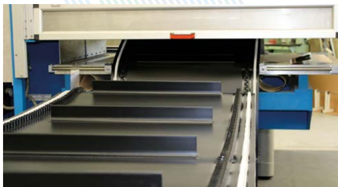
Pose de tasseaux par HF
