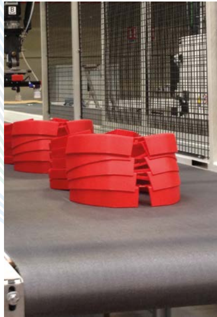
Bande silencieuse avec face porteuse en tissu pour l'accumulation
