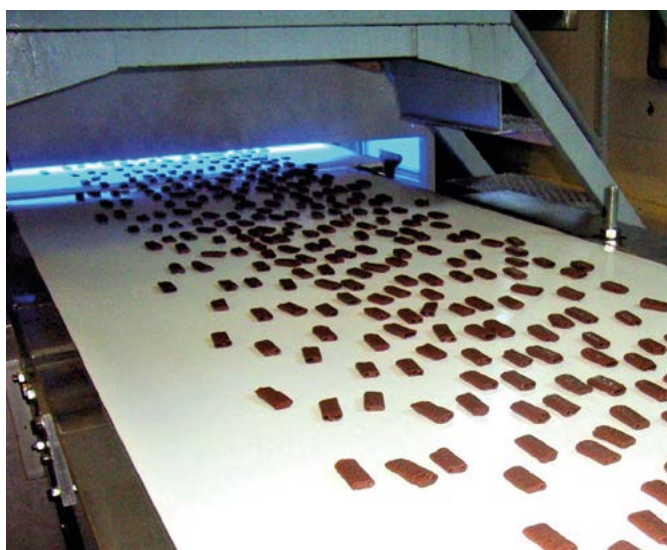
Chocolats en sortie de tunnel de refroidissement
